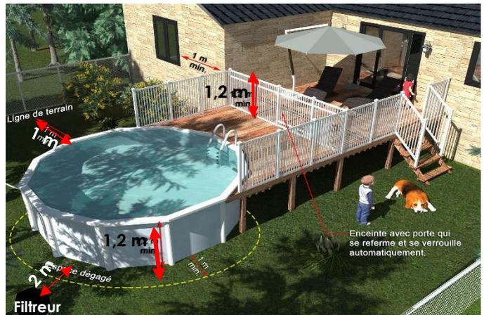
Tout appareil (ex : filtreur) doit être installé à plus de 2 m (6,56 pi) de la paroi d'une piscine ou d'une clôture afin d'empêcher l'escalade, sauf si cet appareil est situé du côté intérieur de l'enceinte entourant la piscine ou s'il est protégé par un bâtiment ou autre structure empêchant son accès.
